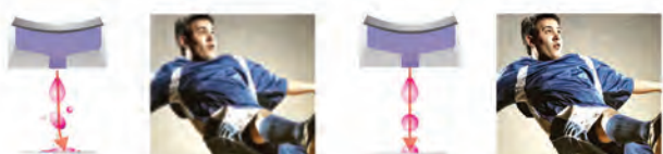
Sem controle Waveform, a gota não forma um círculo perfeito.
